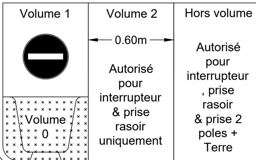
Cet appareil de classe II peut être installé dans le volume 2 de la salle de bain (Il est interdit au dessus de la baignoire ou dans le volume de la douche). Il peut être installé sans restriction dans toutes les autres pièces.
